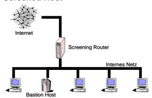
Die Firewall besteht hierbei aus einem Screening Router und einem Bastion-Host, wobei der Bastion-Host selbst im lokalen Netz liegt. Der Screening Router leitet den Datenverkehr auf den Bastion-Host um. Es findet hierbei keine direkte Kommunikation zwischen den lokalen Clients und dem Internet statt, alles muss über den Bastion-Host laufen. Dies regelt der Screening Router, der nur Datenpakete vom Bastion-Host passieren lässt.
