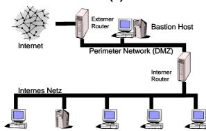
Hierbei kommen zwei Router (intern/extern) zum Einsatz, wobei der Bastion-Host sich in einem eigenen Netzstrang befindet, und von beiden Routern geschützt wird. Der externe Router leitet alle eingehenden Datenpakete an den Bastion-Host weiter. Der innere Router lenkt ebenfalls alle Datenpakete aus dem lokalen Netz auf den Bastion-Host um.
