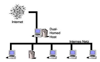
Ein Dual-Homed Host ist eine Maschine, die Paketfilter und Gateway in sich vereint. Hierbei darf allerdings kein Routing zwischen externem und internem Netz stattfinden, da dies den Dual-Homed Host wieder auf die Stufe eines Screening Router zurückfallen ließe. Diese Maschine arbeitet auf der nur Anwendungsebene, worauf die erhöhte Sicherheit in diesem System basiert. Dadurch wird auch der Einsatz spezieller Programme von Nöten, sog. Proxy-Servern.
