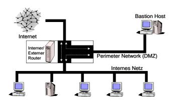
Bei dieser Konzeption ist der zentrale Punkt ein Screening Router mit 3 Schnittstellen. Er routet damit zwischen dem externen Internet, dem lokalen Netz und einem Grenznetz (Perimeter Network), der Demilitarized Zone (DMZ). In dieser DMZ befindet sich der Bastion-Host. Der Router leitet Pakete vom internen Netz an den Bastion-Host in der DMZ und von der DMZ an das externe Internet.
